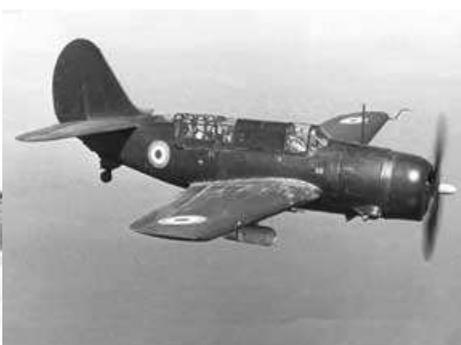
L'Helldiver nasce come aereo imbarcato su portaerei, difatti ha le ali ripiegabili, ed aveva le funzioni di aerosilurante, di bombardiere e tutto e di ricerca antisom. Noi li abbiamo utilizzati soltanto per
