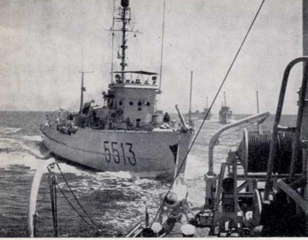
I dragamine sono in grado di effettuare dragaggio meccanico, dragaggio magnetico, dragaggio acustico.
